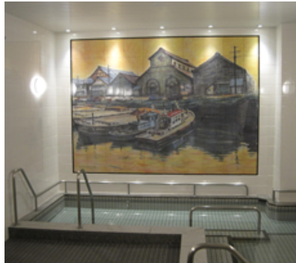
北海道小樽市内高齢者施設浴室 サイズ 縦2.1m 横3.0m 300mm角タイル70枚使用
